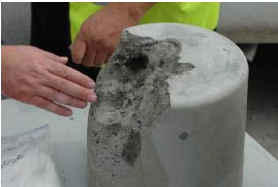
图 7-2 团块状固化/稳定化产物的目测检验
